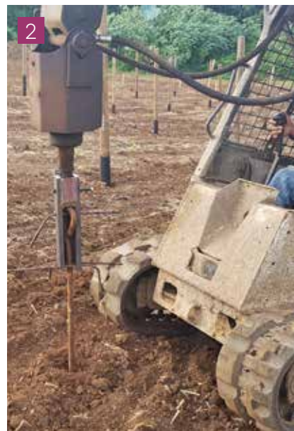
Positionnement des ancrs sur le pourtour du futur verger.
