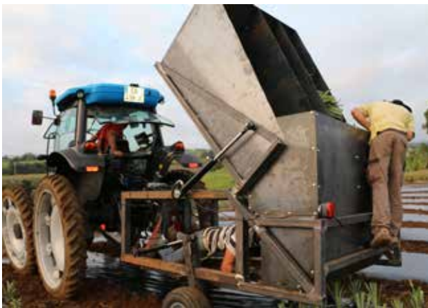
Test au champ du prototype d'assistance à la plantation d'ananas.
