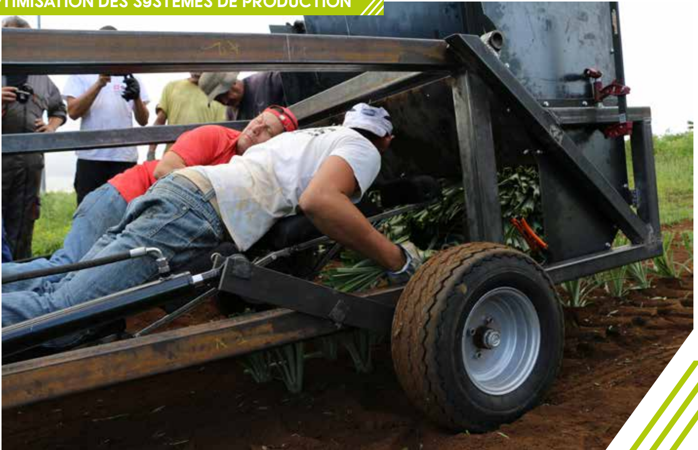
Premier test au champ du prototype d'assistance à la plantation d'ananas.
