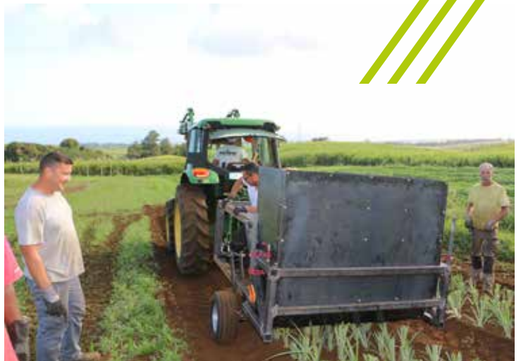
Premier test au champ du prototype d'assistance à la plantation d'ananas.
