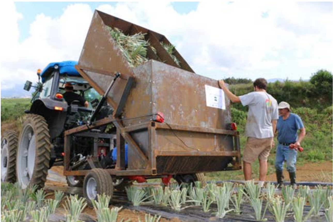
Benne de stockage et trémie de distribution des rejets d'ananas
